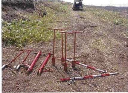
3 専用器具 左からダブル・プランティングチューブ・スベード
