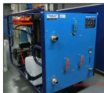
写真：非常用造水機（非常用として取得）
