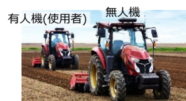
ほ場内からの監視による自動走行
