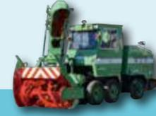
路面に残った雪を回転する赤い刃で取り込み、路肩に雪を飛ばします。
