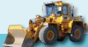
平らになった路面を拡幅したり、交差点の雪を処理します。
