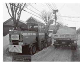
**A** 排雪作業は、安全を確保しながら路肩の雪を削り、ダンプトラックに積んで運搬するなど、作業に時間を要するほか、多くの人員と機械も必要となります。
