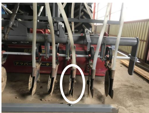
作条深を安定させるため、これまでより大きなコルターに変更
