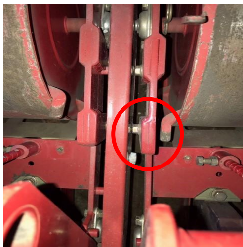
テンパル駆動輪の誤干渉している部品（右側部分）を削って改良。
