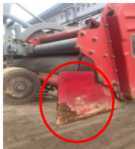
ロータリーに隣畝への土砂流出防止のための部品を装着。
