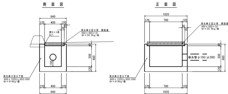
雨水樹II型D布設側面図
