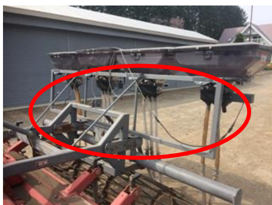
アッパーロータリーにサンソアーを直装できるフレームと 3 点装着部を工作。
