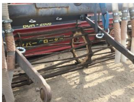
ロータリーとテンパールを連結する 3 点装着部をトラクターから流用。
