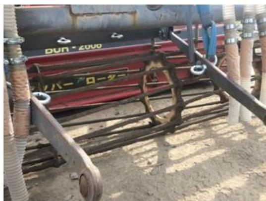
ロータリーとテンパールを連結する 3 点装着部をトラクターから流用。
