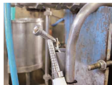
ホース口が床に接触してしまうのを防止するための工夫
