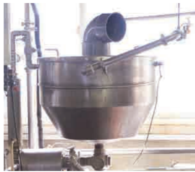
結露が釜に入らないよう蒸気口をR状にした豆乳分離機
