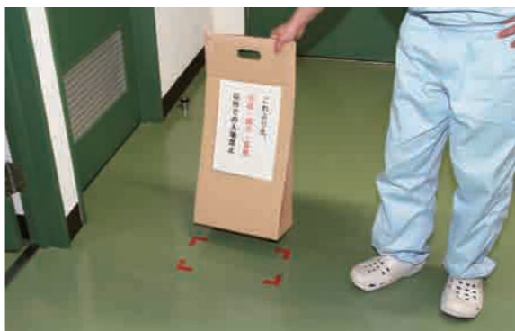
手作りの侵入注意看板の所定位置をテープで表示
