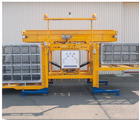
自動化したコンテナフィーラー
