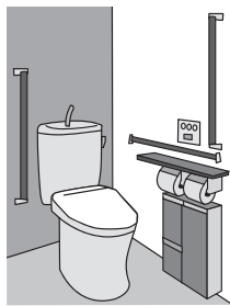
トイレの段差解消、手すり設置
