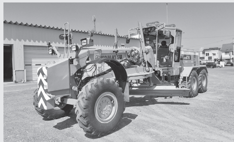
除雪グレーダ（除雪車両）
