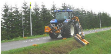
ブームモアを付けたトラクターで道路の法面を刈る様子
