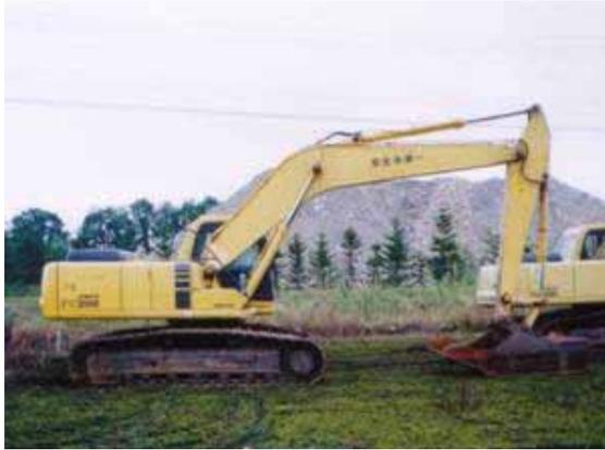
土をふるい、石礫を取り除く除礫専用の器具（除礫バケット）をつけた機械です。
