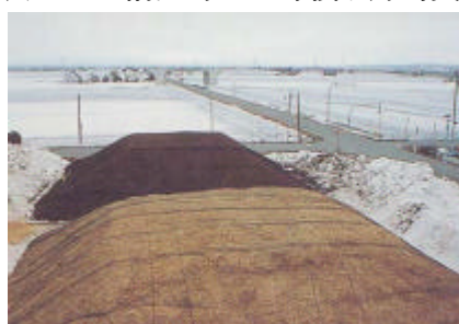
図表 — 沼田町での野積み貯雪実験
