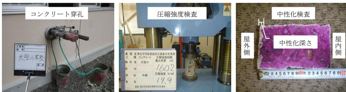
\*コンクリートの中性化：経年によりコンクリート内部のアルカリ成分が失われること。コンクリートの中性化が進行すると内部の鉄筋が錆びやすくなる（酸化しやすくなる）。
