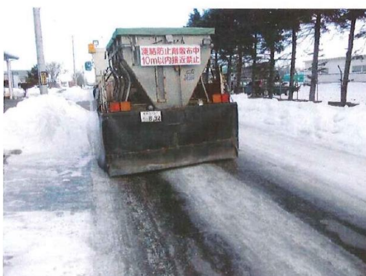
図 4-1.9 焼砂（左：凍結防止剤散布車 右：砂箱）
