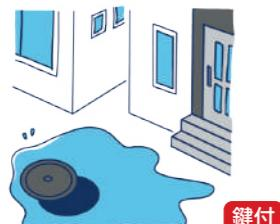
異常水圧による蓋の外れを防止するため、「鍵付きマンホール」の設置を進めています。
