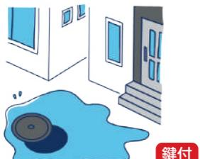
異常水圧による蓋の外れを防止するため、「鍵付きマンホール」の設置を進めています。
